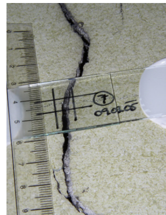
Rissbeobachtung mittels Glasspione
