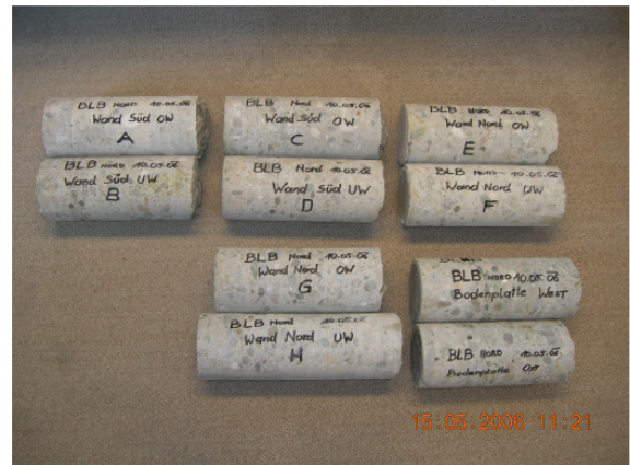
Belebungsbecken: gewonnene Bohrkern
