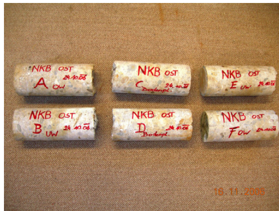
Vorlage der Bohrkerne
