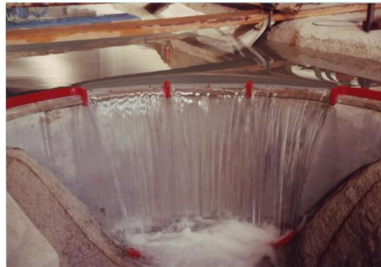
Foto a) Modell der Talsperre Salza; Foto b) Optimierung der Hochwasserentlastungsanlage
